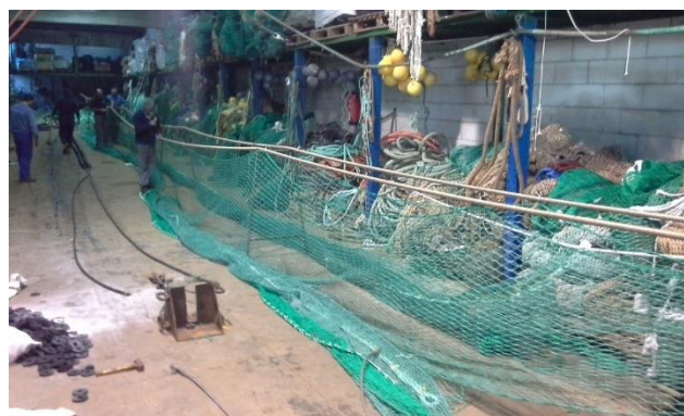
Figura 8 - Imagen del proceso de construcción del arte de pesca por los rederos.
