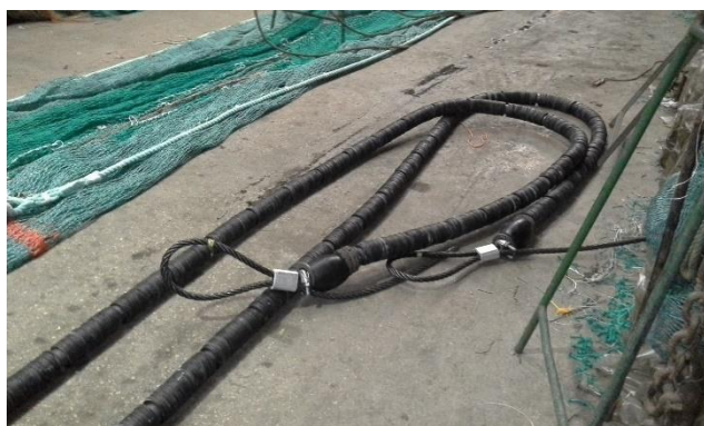
Figura 8 - Imagen de la tralla del plomo lastrada para conseguir darle al arte el peso necesario.
